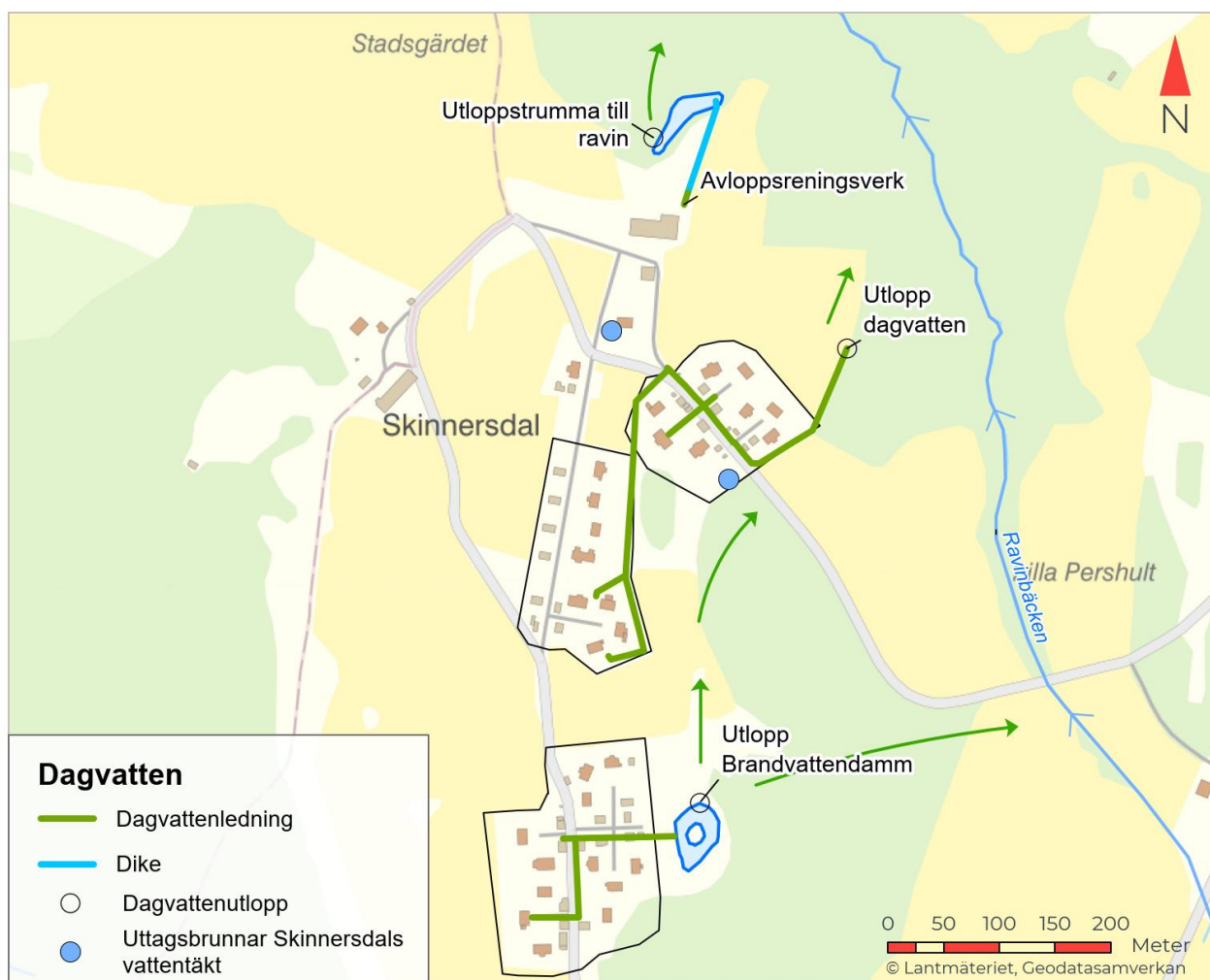
Figur 3. Dagvattensystemet inom och mellan byområdena i Skinnersdal. Ledningarnas placering är tolkade utifrån relationsritning (Gilbert Gustafssons Entr Eksjö, 2005). Gröna pilar markerar tolkad strömningsriktning i öppna diken.
