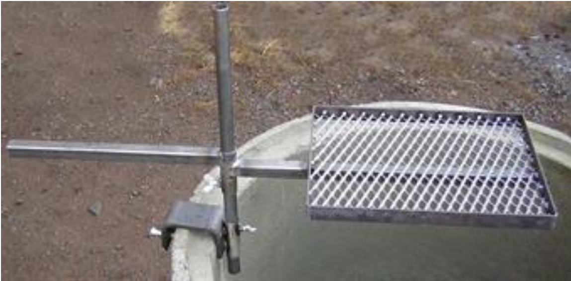
Tänkt galler som fäster på kanten av röret. Grillytan är 50 x 40 cm.
